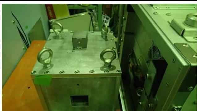
図2 中性子照射のための Xバンド X線非破壊検査装置 (3.95MeV) とターゲットステーションのセットアップ
