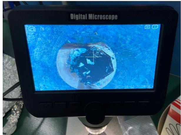
図：ナノファイバー材はイオン照射によって温度が上昇して原型をとどめていなかった。
