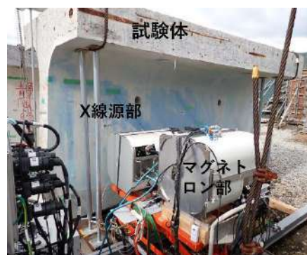
図 4. 0.95MeV の X 線源と橋梁試験体
