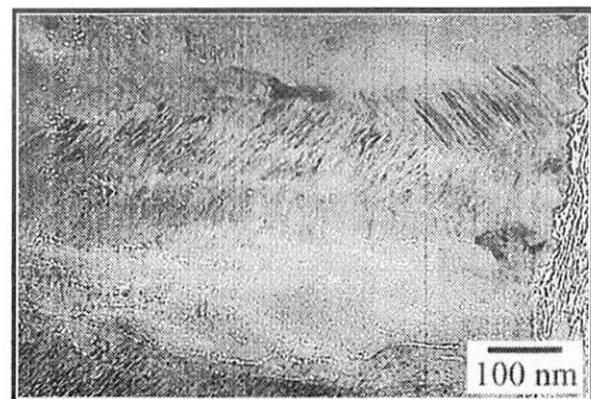
図4 SiCマトリックス中に生成したHeバブル(950°C、He+Cデュアル照射材)
