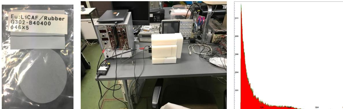
図 3. Eu:LiCAF(左)、光電子増倍管を用いた中性子検出器による Cf-252 のスペクトル測定の様子(中)、および測定されたスペクトル(右)
